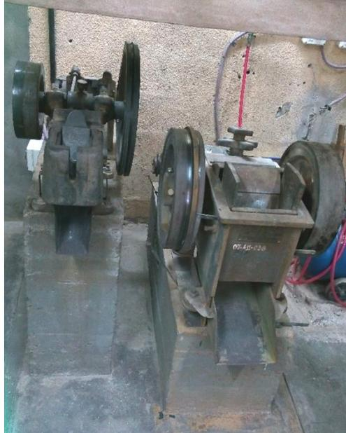
**Foto N 3.-** Vista de las trituradoras durante las tareas de mantenimiento
