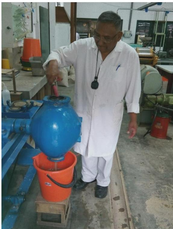
**Foto N 1.-** Ensayos de molienda para la Empresa HANAQ ARGENTINA SA
