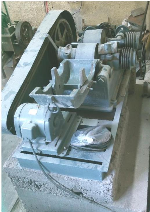
**Foto N 4.-** Vista del molino a rodillo durante las tareas de mantenimiento
